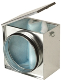
5416592300 - MFL-160 G4 Cajas filtrantes, con filtro MFR-G4 incorporado, tipo Gravimétrico G4 (UNE-EN 779:2003), capaces de filtrar más del 90% de las partículas superiores a 10 micras. Disponen de tapa de abertura fácil, para proceder a un rápido cambio del filtro.
