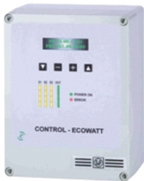
5401613800 - CONTROL ECOWATT AC/DC (90-260Vac 50y60HZ) Elemento de control para sistemas de modulación de los caudales en instalaciones de ventilación de edificios públicos, comerciales o residenciales, que controla continuamente la velocidad de los motores para adecuarse a las necesidades reales, reducir el consumo energético y mantener un ambiente bien ventilado. La gama se compone de tres modelos: <br>CONTROL ECOWATT AC/DC con alimentación monofásica 90-260V 50/60Hz y salida analógica ajustable entre 0-10V para ventiladores con motor de corriente
