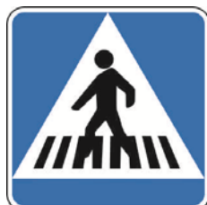
Imatge 4. Senyalització vertical S-13 "localització de pas de vianants"
