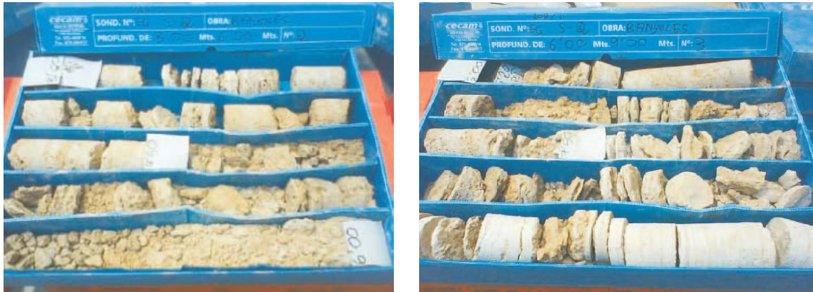
Fotografia 6 i Fotografia 7. Testimonis de travertins entre 3 i 9m de profunditat, en un sondatge perforat en el sector del Museu Arqueològic Comarcal (CECAM, 2011).
